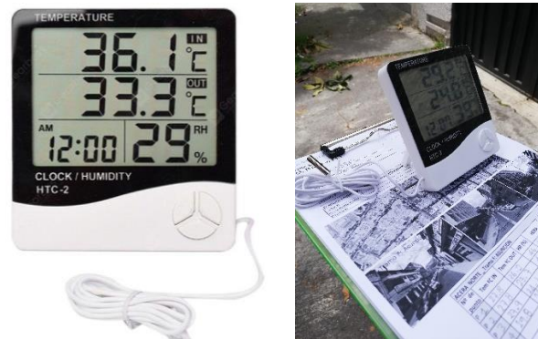
Figura 116: Higrohidrómetro digital HTC-2
